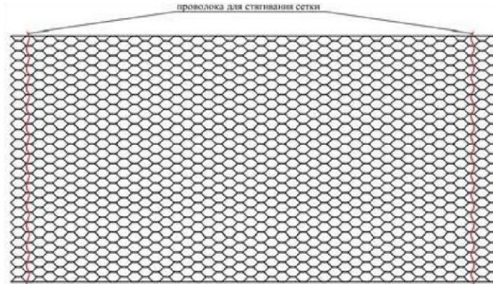
Рис. 8.2 Развёртка цилиндрической габионной конструкции
