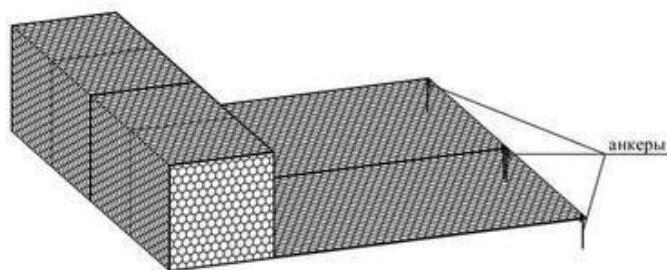
Рис. 7.7 Установка анкеров по краям армирующей панели
