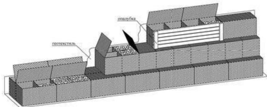
Рис. 5.8 Формирование сооружения из коробчатых габионных изделий
