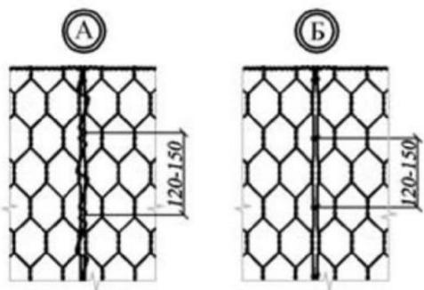
Рис. 5.6 Перевязка элементов габиона
