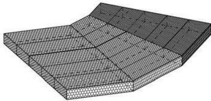
Рис. 6.12 Резка матрасно-тюфячных габионных конструкций
