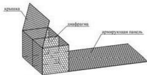
Рис. 7.3 Собранная коробчатая габионная конструкция с армирующей панелью
