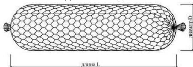
Рис. 8.1 Цилиндрический габион
