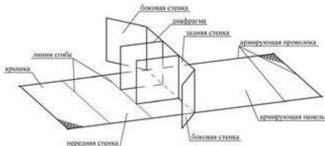
Рис. 7.2 Развёртка коробчатого габиона с армирующей панелью
