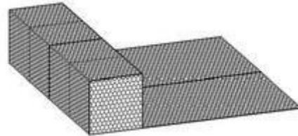
Рис. 7.6 Установка крышки коробчатых габионных конструкций с армопанелью
