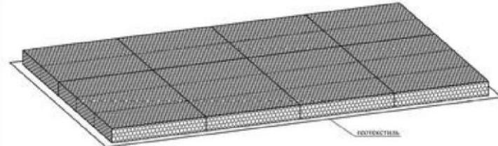
Рис. 6.9 Установка крышки матрасно-тюфячных габионных конструкций
