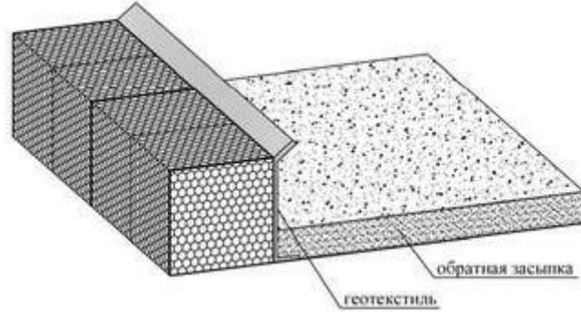
Рис. 7.8 Послойная обратная засыпка армирующей панели
