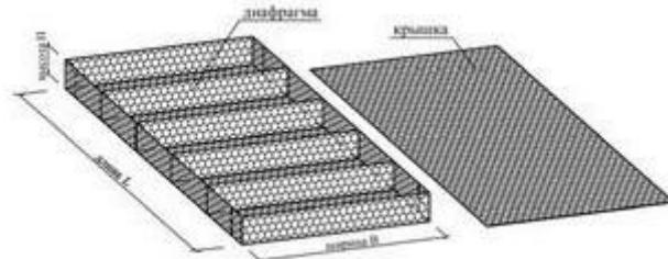
Рис. 6.1 Конструктивная схема габионных конструкций матрасно-tüфячного типа
