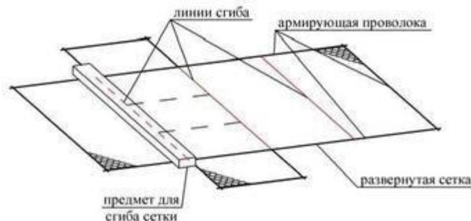
Рис. 5.3 Развёртка коробчатого габиона
