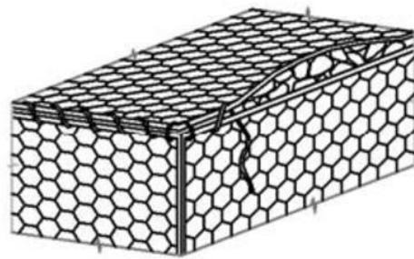
Рис. 5.15 Установка крышки габиона
