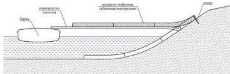
Рис. 6.14 Погрузка матрасно-тюфячных габионов, заполненных камнем, под воду при помощи плавсредств
