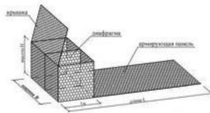
Рис. 7.1 Конструктивная схема коробчатых габионов с армопанелью
