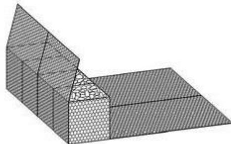
Рис. 7.5 Заполнение коробчатых габионов с армирующей панелью
