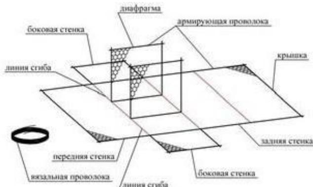
Рис. 5.4 Установка диафрагм в коробчатой габионной конструкции
