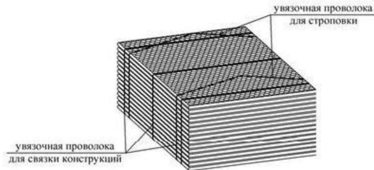
Рис. 5.2 Пачки (пакеты) с габионными конструкциями
