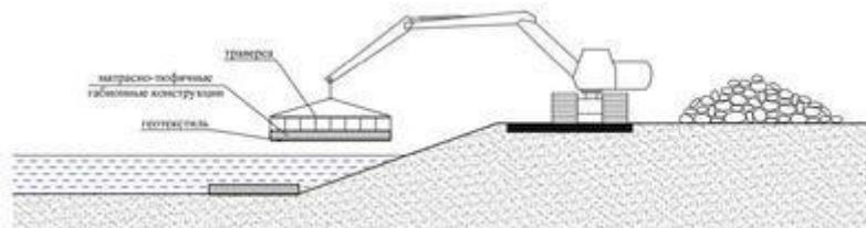
Рис. 6.13 Погрузка матрасно-тюфячных габионных конструкций, заполненных камнем, под воду краном или экскаватором
