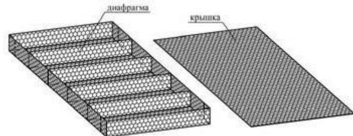
Рис. 6.3 Собранная матрасно-тюфячная габионная конструкция
